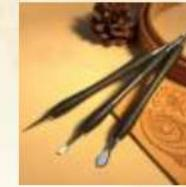
**Кардина** - приспособление, похожее на стилус, наконечники к ней могут быть разных форм - также используется при тиснении. С ее помощью можно
