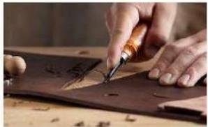
**Канавкорез (грувер)** - позволяет сделать специальную канавку для шва. Тогда нитка будет расположена ниже поверхности кожи и не перетрется при использовании.
