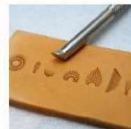
**Штамп** - используется в технике тиснения по коже для создания рельефного отпечатка.
