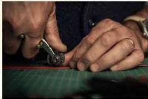
**Роликовый маркер** намечает отверстия для ручной прошивки. Шаг между зубьями определяет длину стежка.
