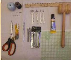
**Рейсфедер** нужен для точной разметки швов, отверстий и мест расположения фурнитуры.
